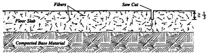
Şekil 17- Önerilen kuğu eklemi tipik detayı
