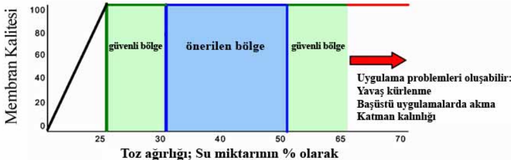
Şekil 1: Su eklenmesi ve kürlenmiş membranın performansı
